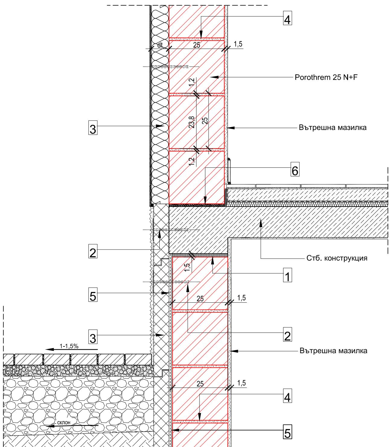
**1.** - PU пяна (размерът на фугата зависи от провисването на стб плоча и се определя от конструктура)
